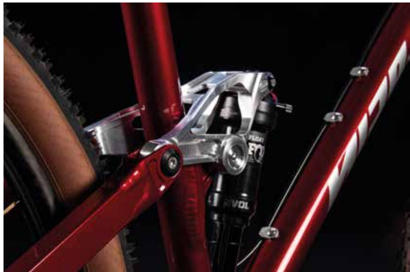
På cyklar med fjädring kontrollerar länkaget det bakre hjulets dämpning. Mottot är här så styv och lätt som möjligt, (bild: Nicolai)
