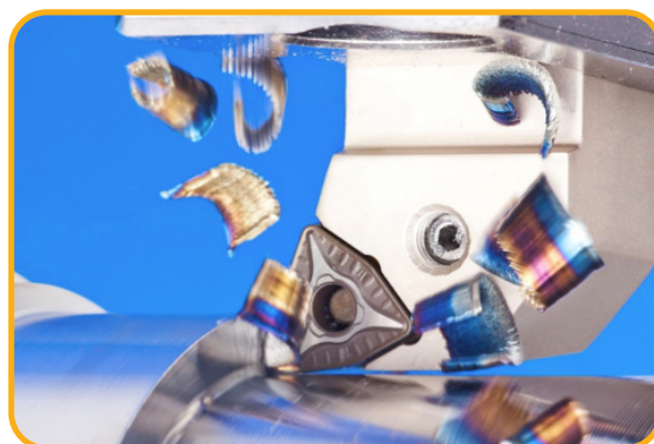
Posuw aż do f=0.65 mm/obr
