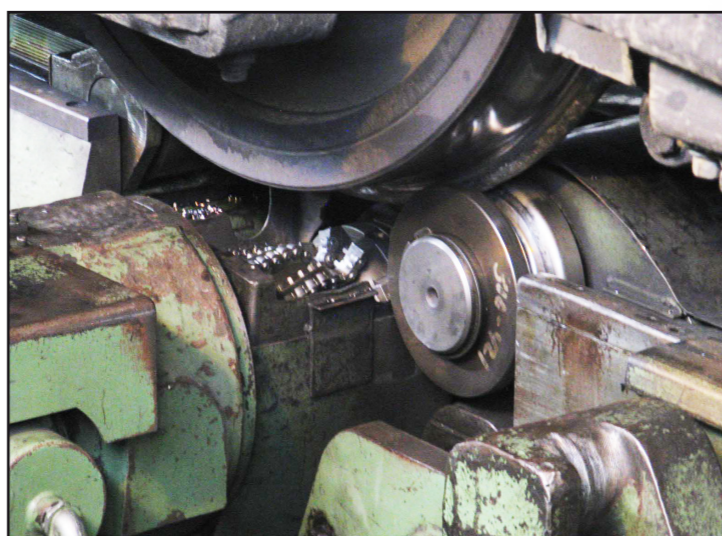
Возможна одновременная обработка всей колесной пары с высокой точностью профиля и сохранением размеров колес.
