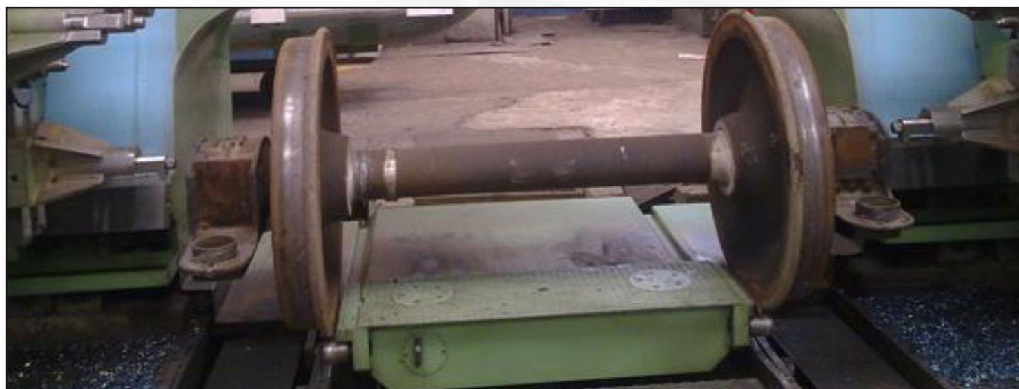
Портальный колесотокарный станок с ЧПУ
